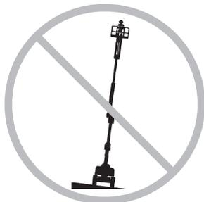
No eleve la pluma si la máquina no está nivelada. No sitúe la máquina en una superficie donde no se pueda nivelar exclusivamente con los estabilizadores.
