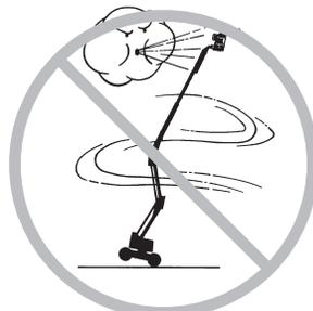
No utilice la máquina en presencia de viento fuerte o racheado.
