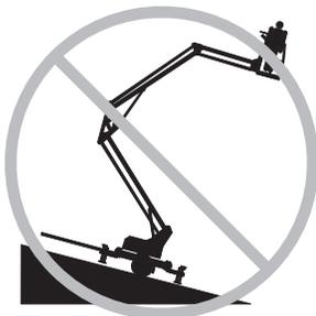
No eleve la pluma si los cuatro estabilizadores no están bajados, los soportes no están en contacto firme con el suelo o la máquina no está nivelada.
